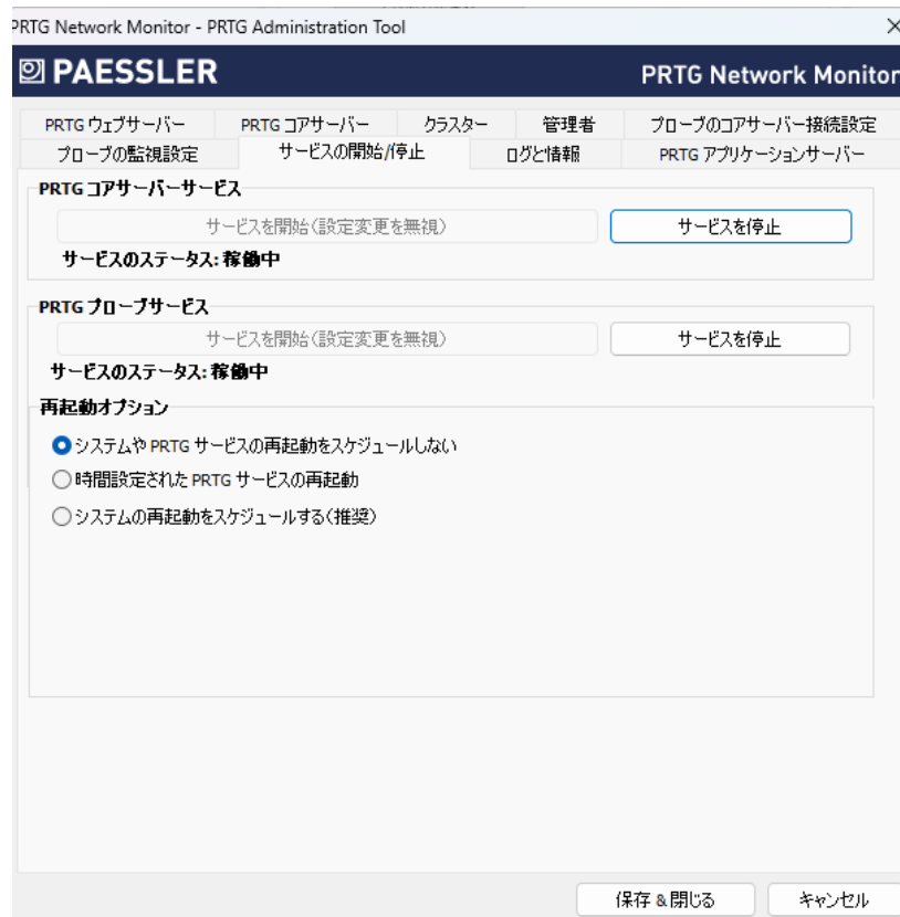
PRTG コアサーバーサービス/PRTG プローブサービスの停止
